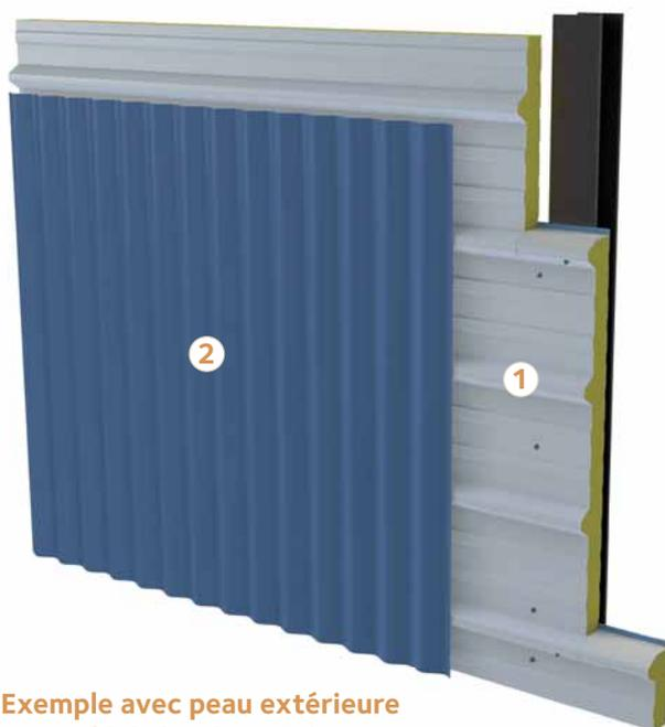
Exemple avec peau extérieure en profil de bardage Fréquence
